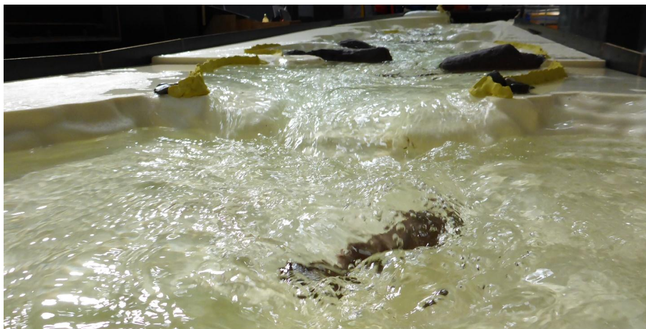
Obr. 3 Fyzikální model po úpravách s průtokem 10 l/sec
