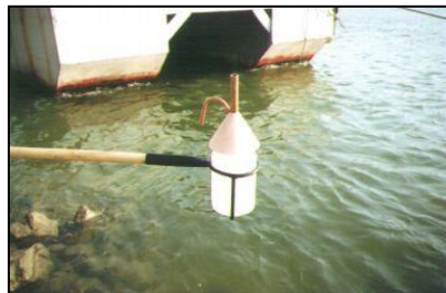
Obrázok 1 Brehový odber 1 litrovou PVC fľašou.
