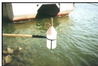
Obrázok 1 Vzorkovnica na odber plaveninových vzoriek.
