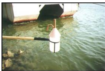
Obrázok 1 Vzorkovnica na odber plaveninových vzoriek.
