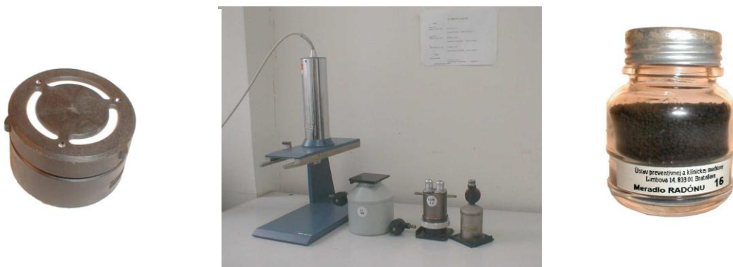
Obr.č. 8: Detektor stôp v pevnej fáze typu CR-39 v difúznej komôrke (dlhodobé merania), scintilačné komôrky (Lukasové komôrky) rôznych objemov s fotonásobičom a detektor objemovej aktivity radónu na báze aktívneho uhlia (krátkodobé merania)
