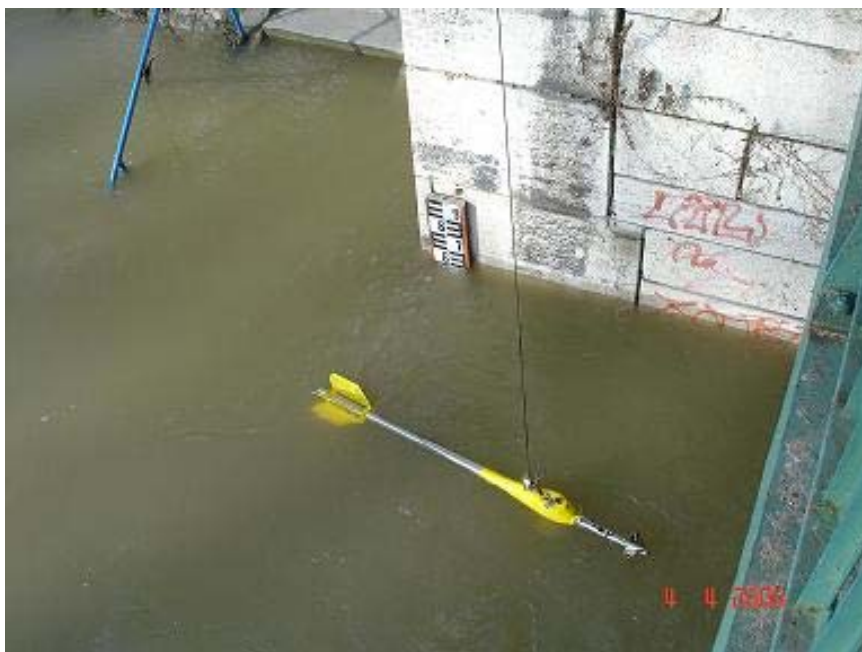
Obr. 5, 6 Meranie klasickou vrtuľovou metódou (meracia skupina a torpédo s vrtuľou)
